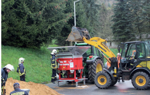
Füllung der Sandsäcke mit dem „Power King 800“ auf dem Gelände der Feuerwehr Sebnitz
